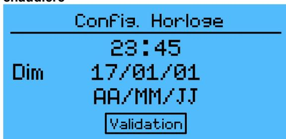
Ce menu permet l'ajustement de l'horloge interne du contrôleur. Vous devez ajuster l'heure, les minutes, ainsi que la date aux cases présélectionnées afin que l'horloge soit correctement réglée. Cet ajustement est nécessaire afin de permettre le fonctionnement des fonctions :
