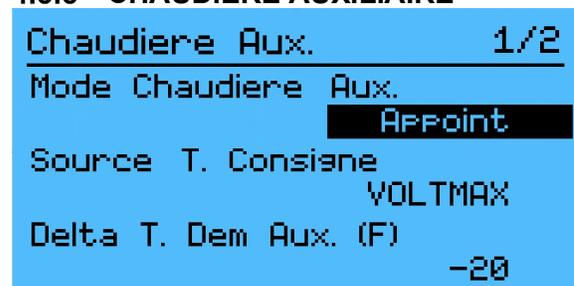
Le programme du contrôleur a été conçu pour permettre l'opération d'une seconde chaudière ou d'une chaudière auxiliaire alimentée par une autre source d'énergie.
